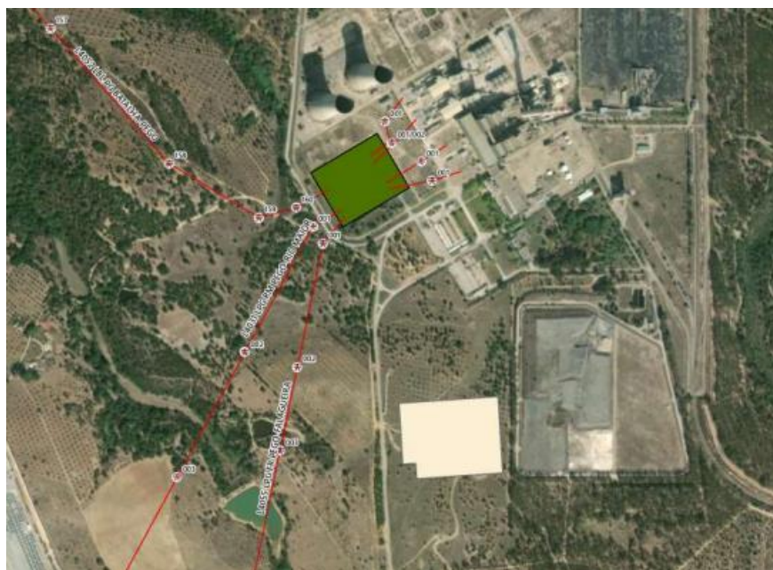
Figura 2.2 – Localização do atual Posto de Corte do Pêgo (a verde) e Linhas elétricas existentes, a 400 kV (a vermelho) e localização do novo Posto de Corte de Abrantes (a branco) (Fonte: Memórias Descritivas dos Projetos de Execução “Ligação do novo PC Abrantes à RNT - Painéis Sul e Norte”)
