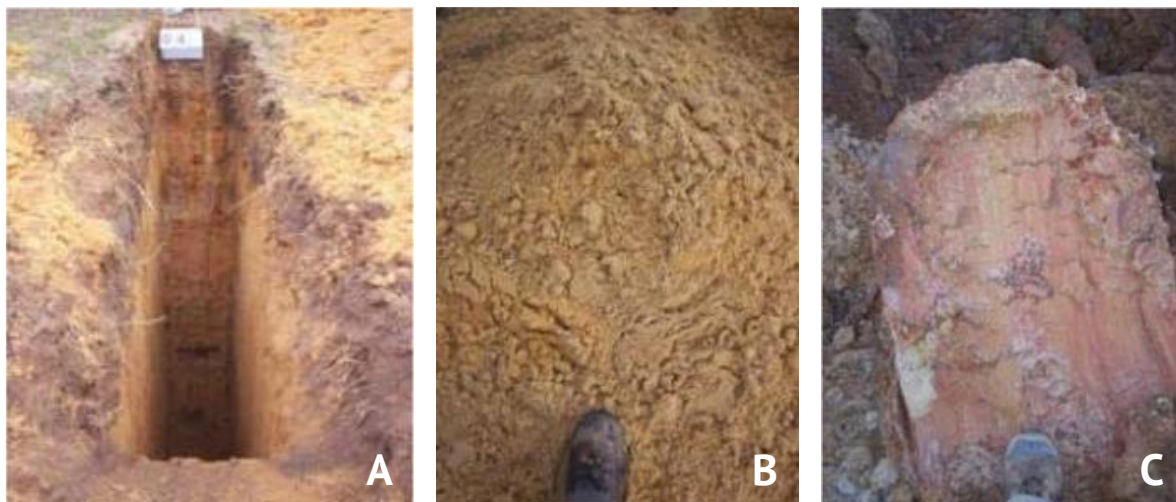
Figura 5.2 – A: Aspeto geral de um dos poços escavados na área de implantação da central solar. B: Camadas arenosas observadas no local. C: Exemplo de níveis argilosos identificados em profundidade durante a prospeção
