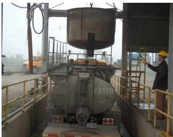
Foto 4.5 – Exemplo de sistema de transposição trap and truck (Fontes: Hinze, 2007 à esquerda e Pompeu e Martinez, 2005a à direita).
