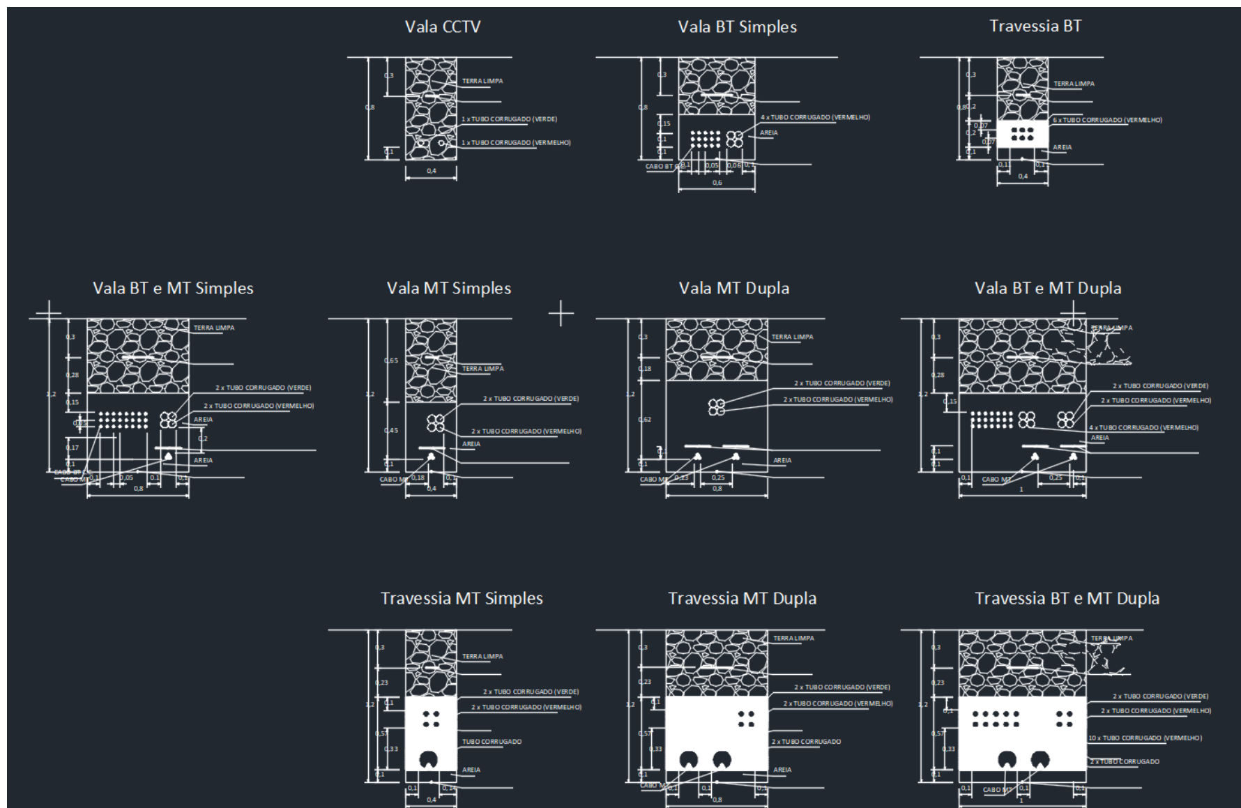
Figura 8: Perfis transversais das valas de cabos
