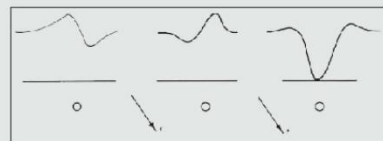
Anomalías típicas producidas por un objeto enterrado dependiente de la dirección en que ha sido cruzado.
