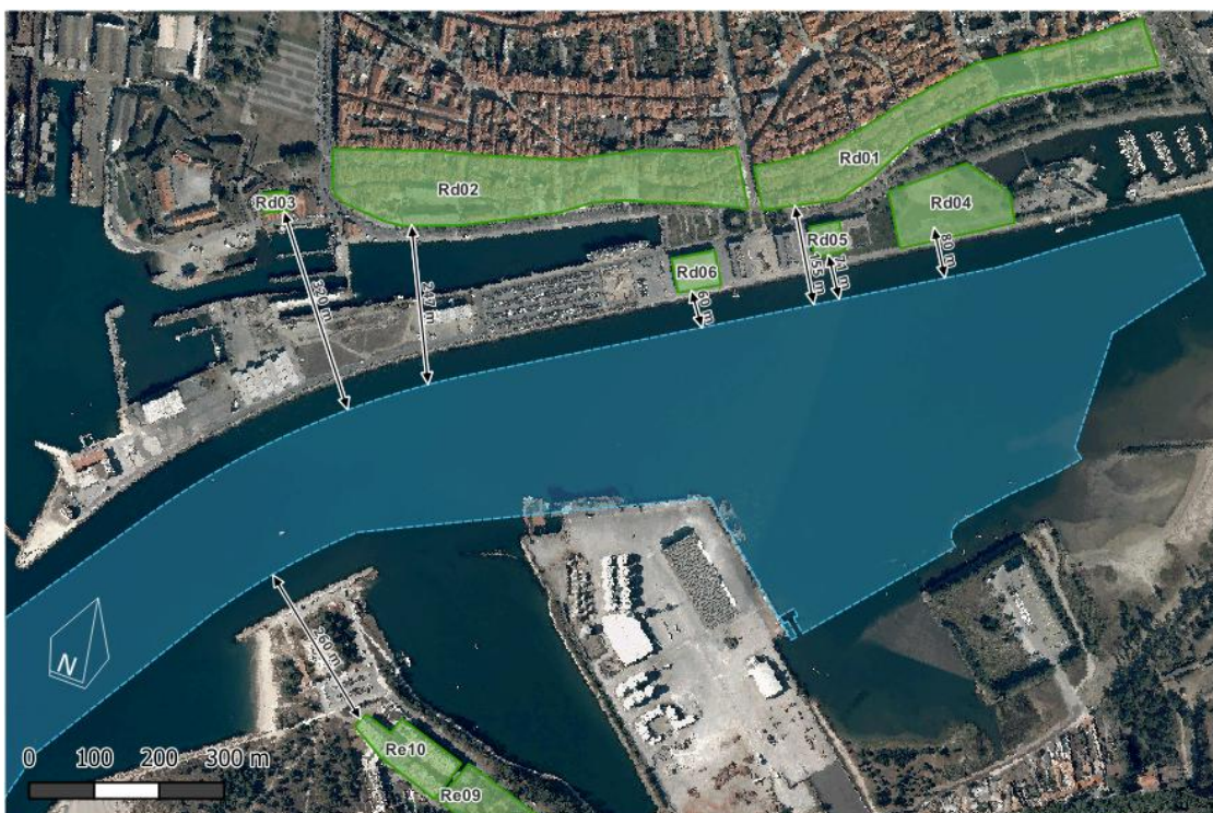
Figura 299 – Potenciais Recetores Sensíveis (verde) e área de dragagem.
