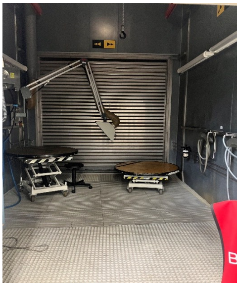
Figura 9 – Exemplo de como será a cabine onde ocorre a FPI
