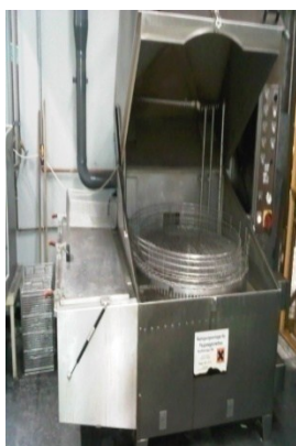
Figura 16 – Exemplo de máquina de lavagem por spray
