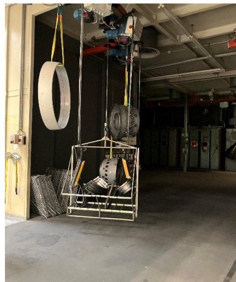
Figura 8 – Exemplo da preparação da entrada dos materiais no sistema de quindaste com cordas
