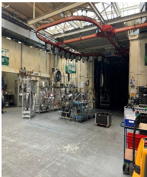
Figura 7 – Exemplo de uma entrada da linha FPI com cestos.
