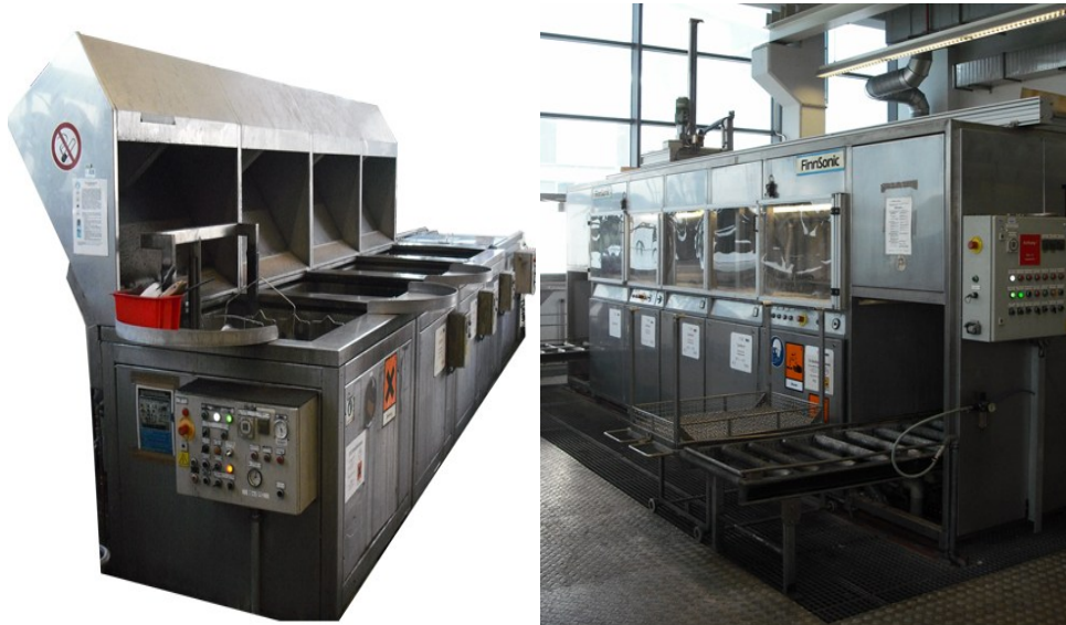
Figura 21 – Exemplos de máquinas quickturn (à esquerda a versão aberta e à direita a versão fechada)
