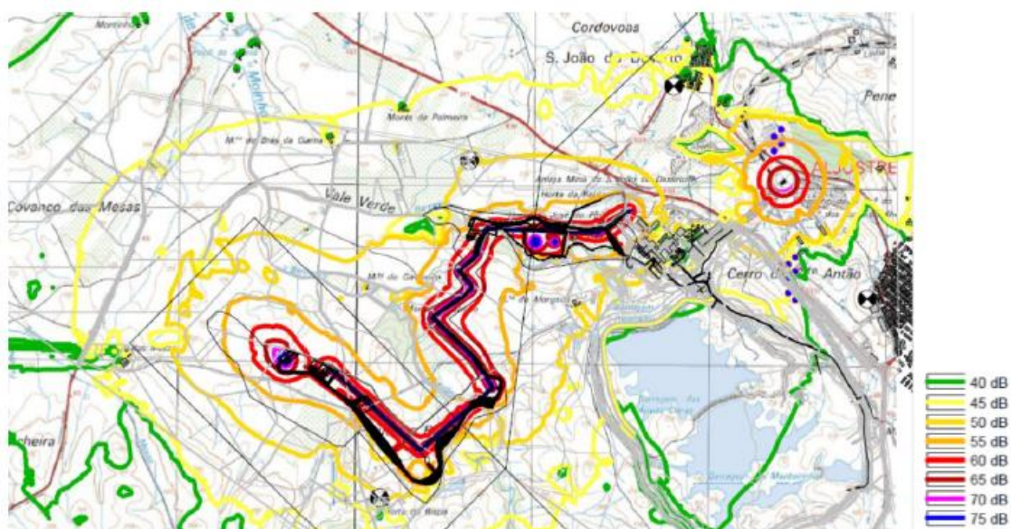
Figura 44 - Mapa de ruído particular da situação de exploração da mina, com medidas de minimização, indicador de ruído diurno-entardecer-noturno ( L_{den} ) Fonte: adaptado do RS do EIA, 2026.
