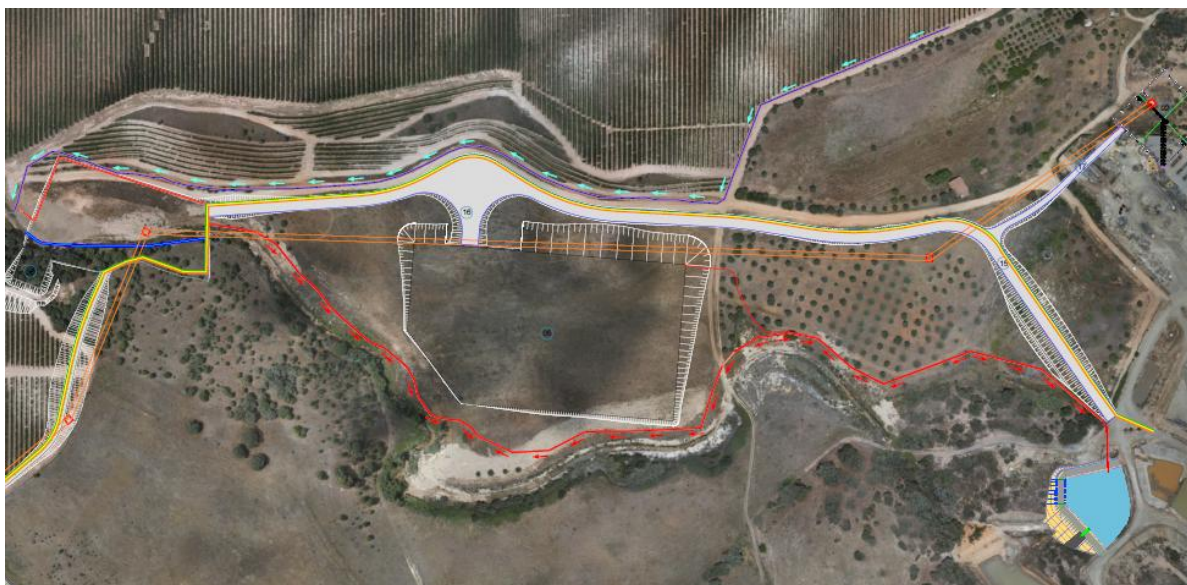
Figura 11- Sistema de Drenagem Superfície
