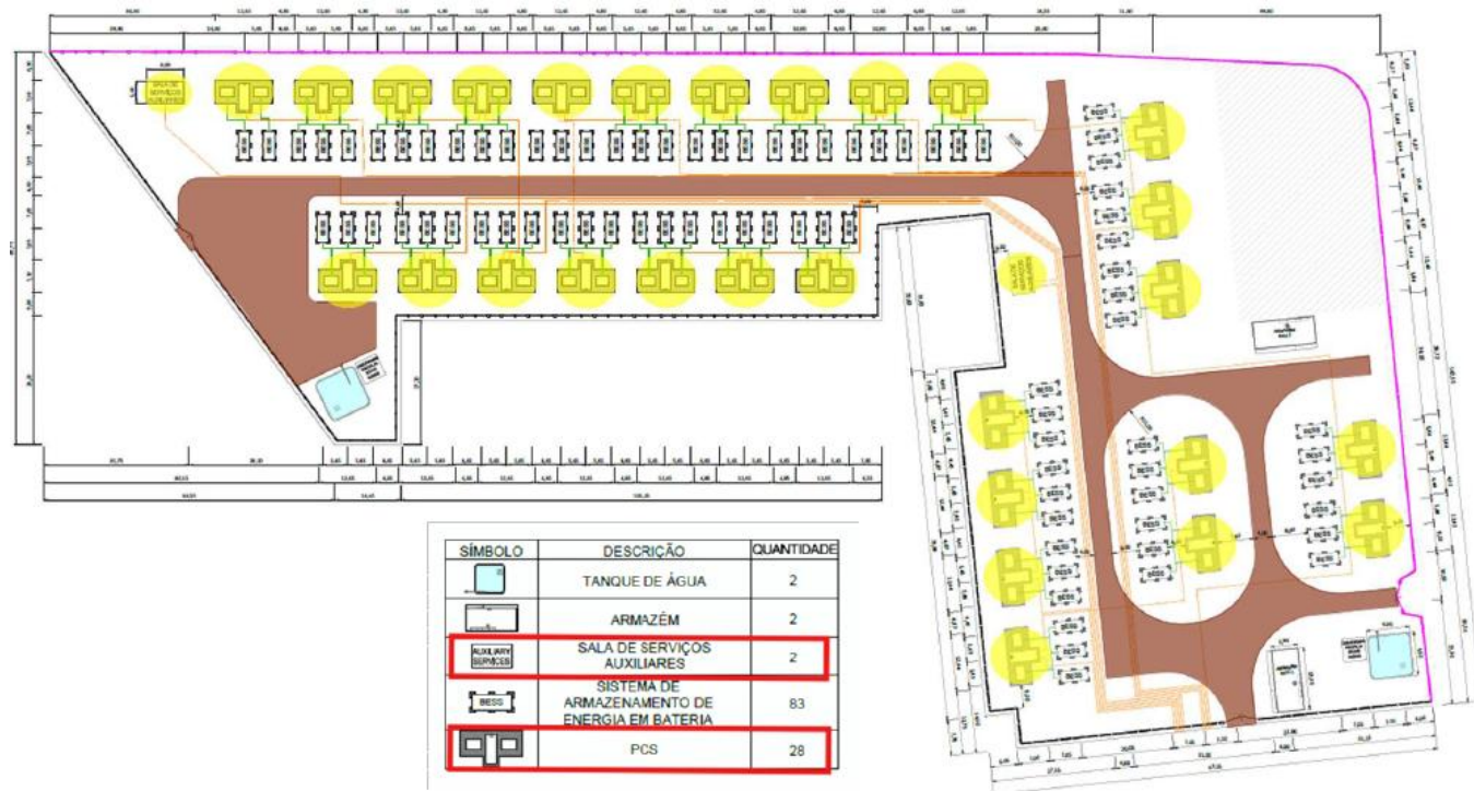
Figura 2.5 – Localização das bacias de retenção (círculos a amarelo) no Parque de Baterias
