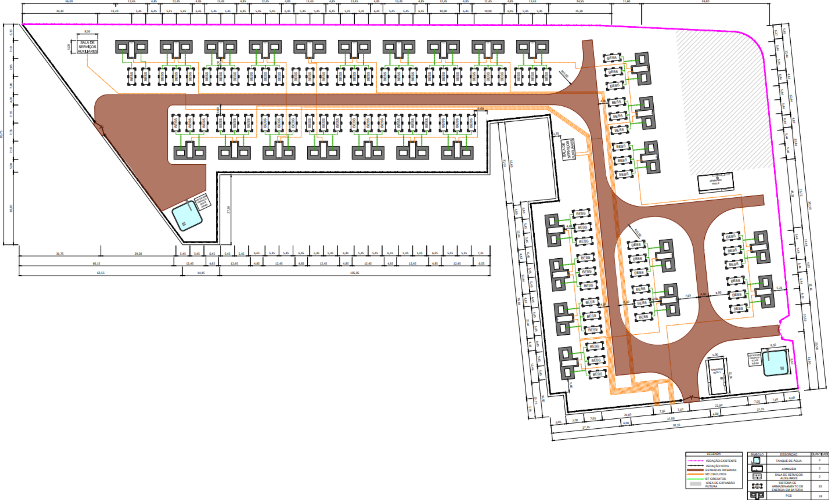
Figura 8 - Disposição de equipamentos de armazenamento do projeto BigBATT
