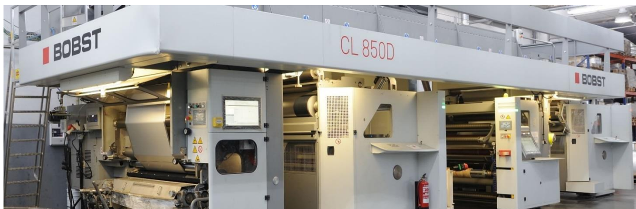
Figura 7 - Registo fotográfico de um equipamento de complexagem com solven
