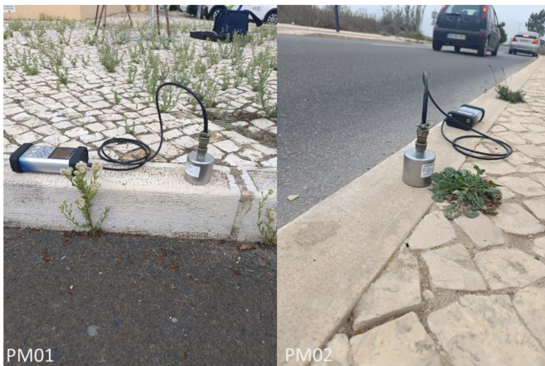
Figura 70 – Registo fotográfico dos pontos de medição de vibração
