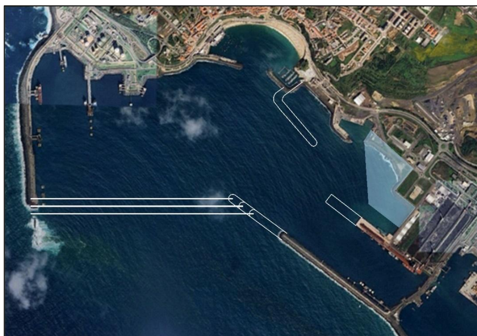
Fig. 75 –Prolongamento do Molhe Leste (300, 400 e 500 m)
