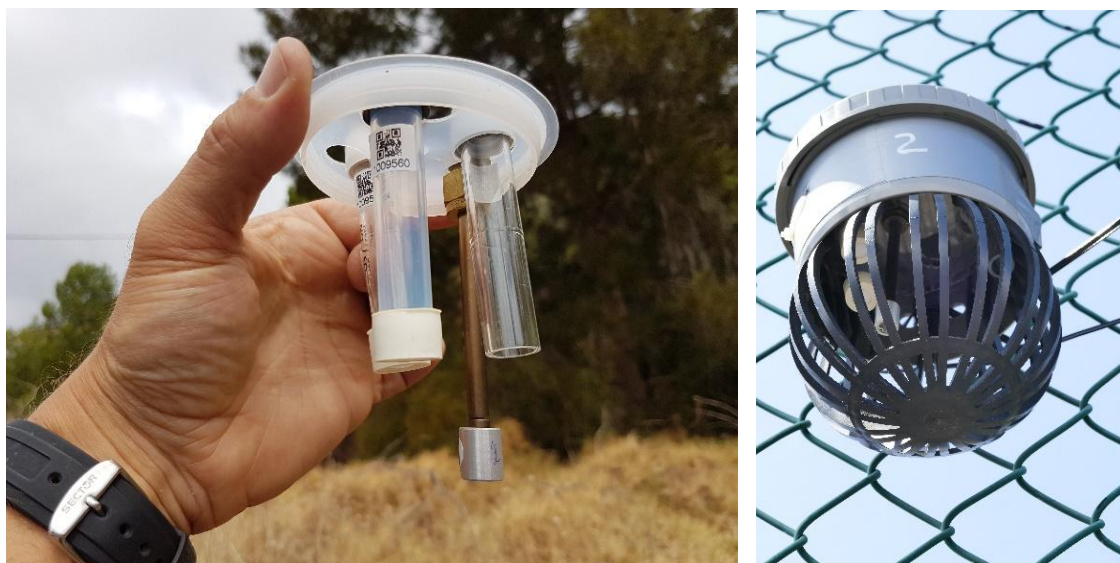
Figura 4.13 - Amostradores passivos e respetivo suporte
