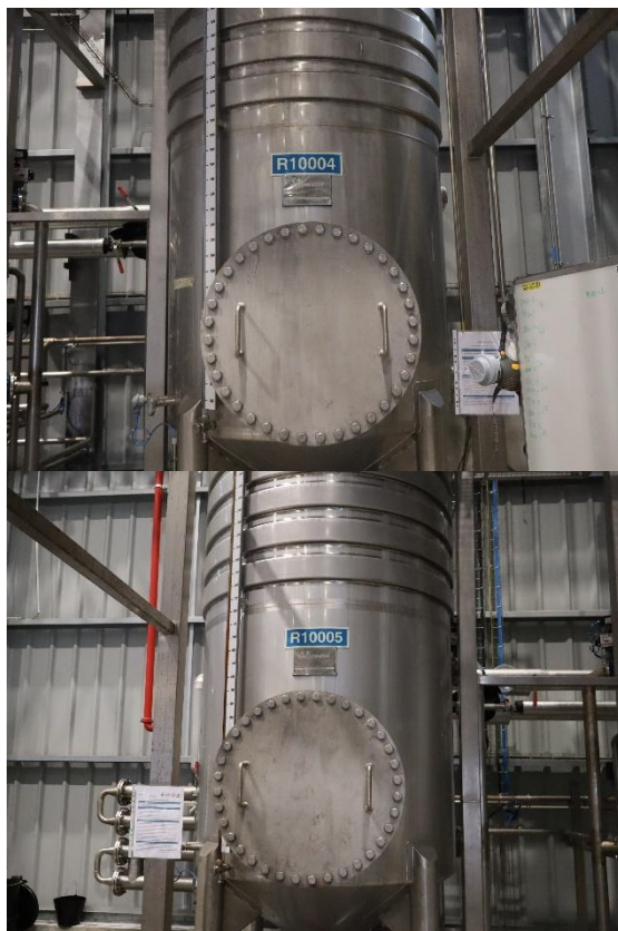
Fotografia 3.4 - Reatores onde se obtém o metilato de potássio.
