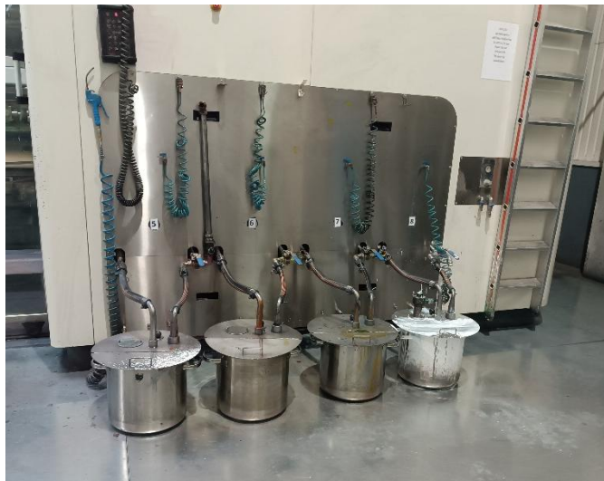
Figura 10 – 4 depósitos que constituem o sistema de alimentação de tinta da impressora VI4.
