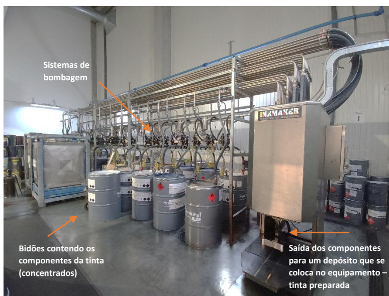
Figura 9 – Equipamento de preparação de tintas designado por dosing
