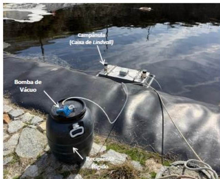
Figura 1 – Amostragem na Bacia de Lixiviados.
