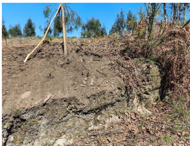
Figura 33 – Corte recente expondo o horizonte orgânico delgado superficial sobrejacente a um horizonte mineral arenoso.
