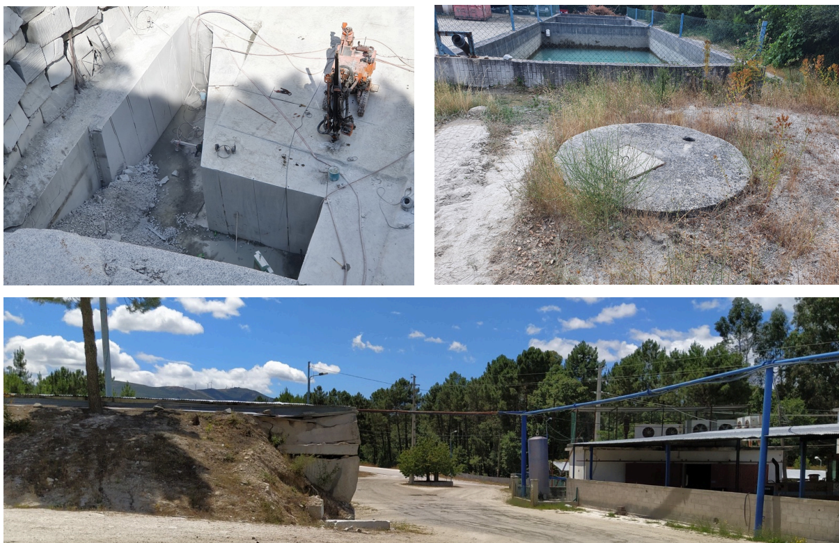
Figura 74: Fotografia da frente de exploração evidenciando o consumo de água pelas máquinas de fio diamantado e a tubagem para o transporte da água.
