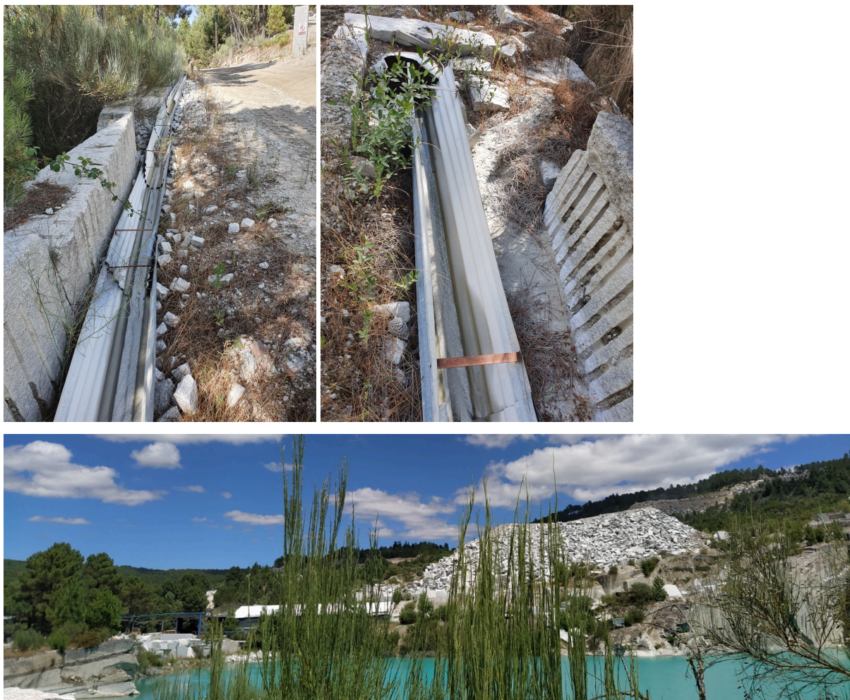
Figura 13: Fotografia da caleira de transporte de água proveniente do corte com as máquinas de fio diamantado e a lagoa formada no vazio da escavação da Pedreira nº 4813 “Ribeiral”.
