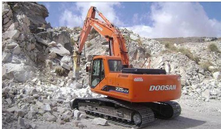
Figura 17 – Escavadora giratória equipada com martelo hidráulico.
