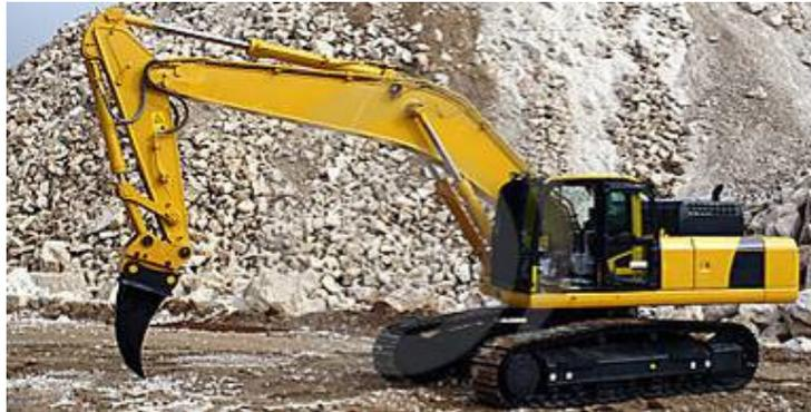
Figura 16 – Escavadora giratória equipada com ripper.
