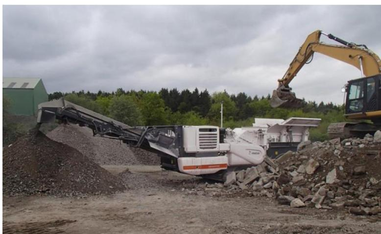
Figura 24 – Imagem exemplificativa da instalação de britagem móvel.
