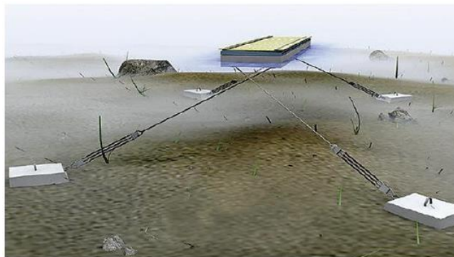
Figura 5 – Exemplo da amarração ao fundo da barragem com recurso a extensores
