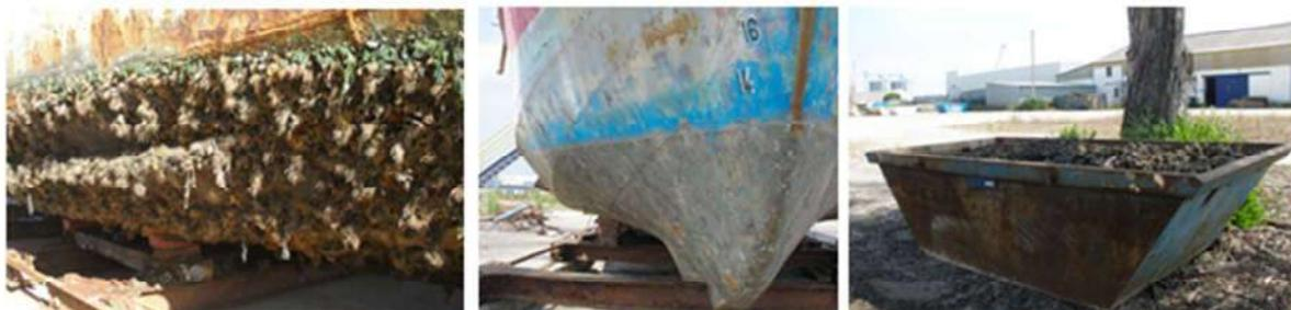
**Figura 2.17-** Limpeza do casco do navio.
