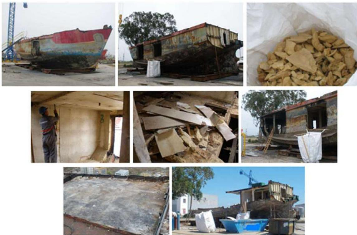
**Figura 2.18-** Abertura(s) de acesso ao navio facilitando ventilação dos espaços e movimentação dos resíduos a retirar do interior.
