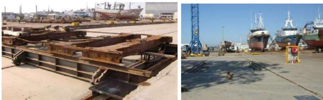
**Figura 2.3-** Plano horizontal – carro transfer e carreira de encalhe de navio, respetivamente.
