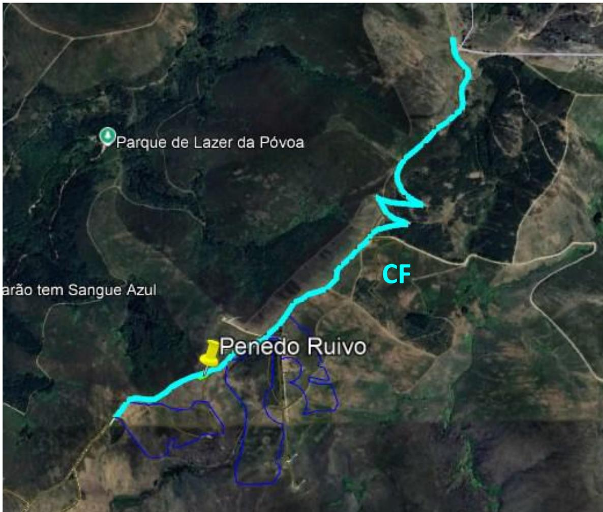
Os trabalhos de beneficiação a executar na revê viária externa sem pavimentação (*tout-venant*) – CF, consistirão essencialmente na reabilitação funcional da estrutura do pavimento da via existente e a reabilitação das valetas de drenagem, assim como o encaminhamento das águas.
