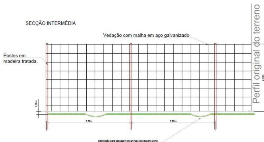
Figura 10 – Detalhe da vedação proposta (Fonte: PDA)..
