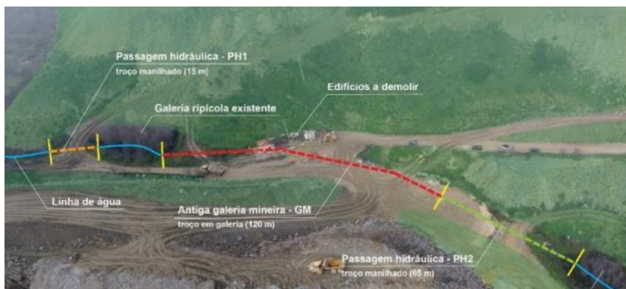
Figura 24 – Intervenções realizadas na linha de água
