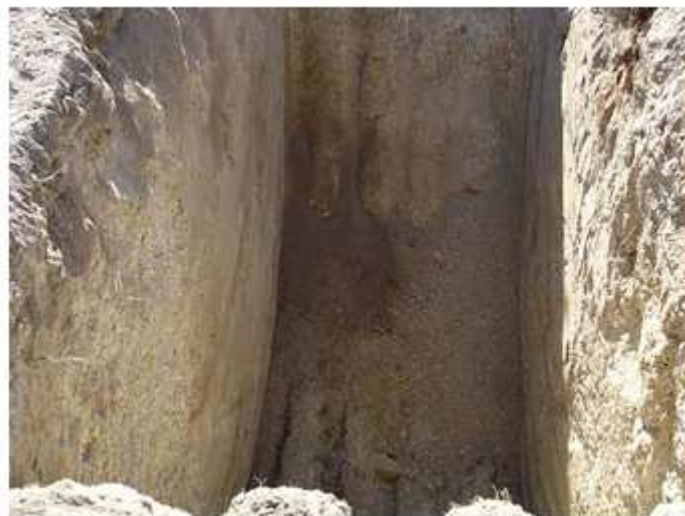
Figura 6.2.3.2- Sondagem para a recolha de amostras para análise do solo.
