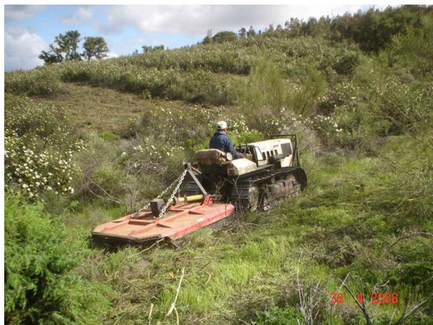
**Figura 24** – Tractor com destroçador
