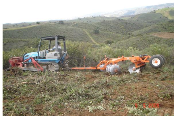
**Figura 25** – Tractor de rastos com rodas de discos.
