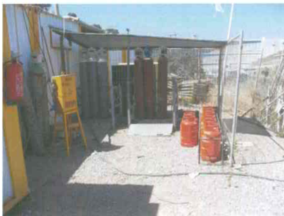
Figura 2: Local de armazenamento de gases limpo (ausência de vegetação).
