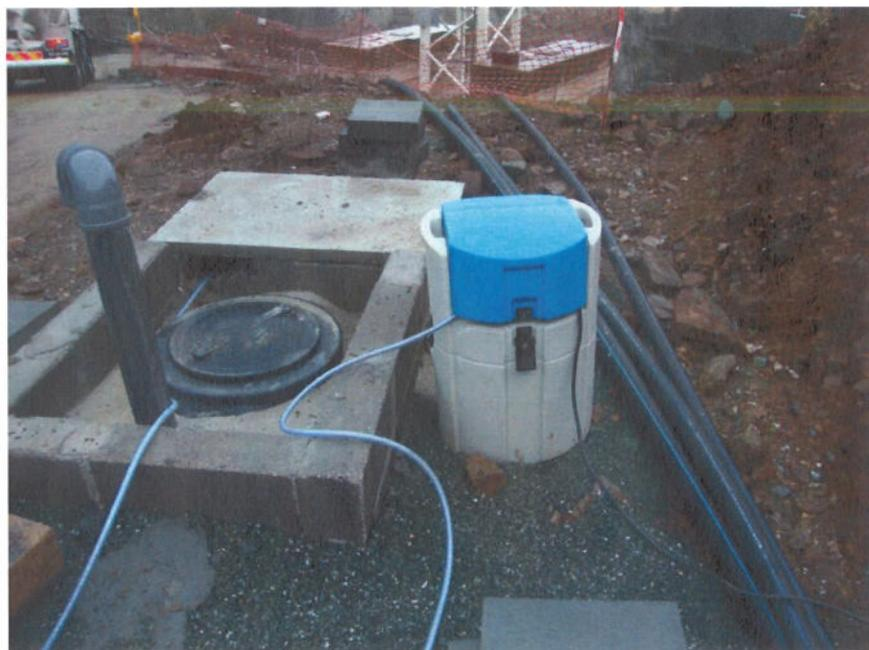
**Fig. 37 – Recolha de amostra composta do sistema de decantação dos efluentes da escavação**
