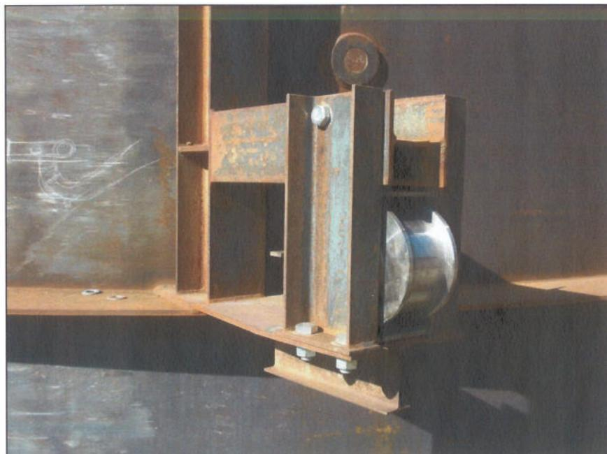
Fig. 32 – Chassis com rodas
