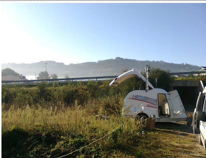
Figura 3 – Perspectiva da estação móvel de qualidade do ar durante as medições realizadas no local PK21+150 do Sublanço Barcelos – Braga Oeste (A3) – Braga (Ferreiros).
