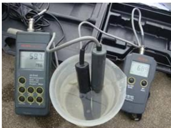
Fotografia 4: Medição do pH, Temperatura, Condutividade e Oxigénio Dissolvido com recurso a sondas portáteis
