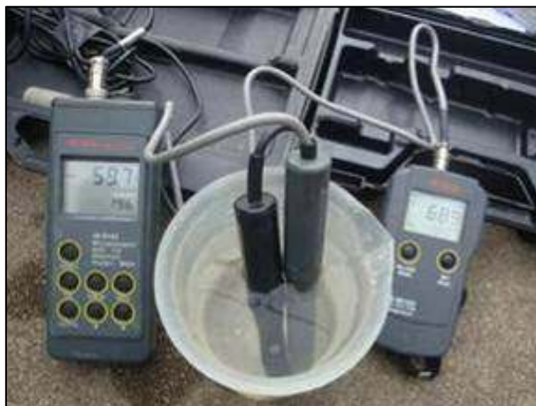
Fotografia 6: Medição do pH, Temperatura, Condutividade e Oxigénio Dissolvido com recurso a sondas portáteis
