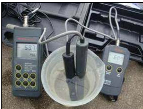
Fotografia 2: Medição do pH, Temperatura, Condutividade e Oxigénio Dissolvido com recurso a sondas portáteis
