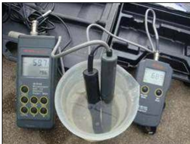
Fotografia 2: Medição do pH, Temperatura, Condutividade e Oxigénio Dissolvido com recurso a sondas portáteis
