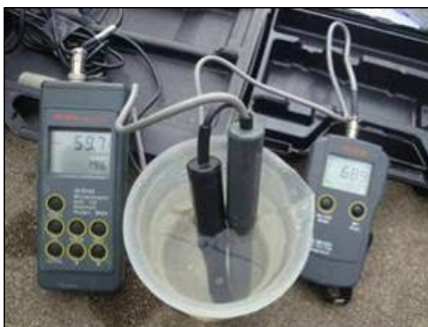
Fotografia 4: Medição do pH, Temperatura, Condutividade e Oxigénio Dissolvido com recurso a sondas portáteis
