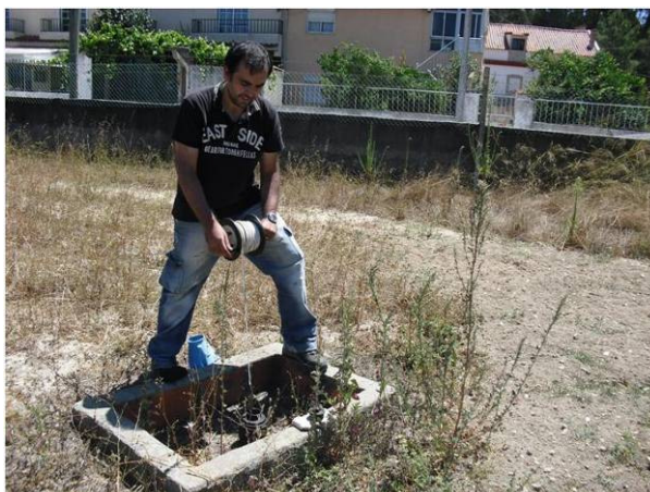
Fotografia 5: Medição da coluna seca com recurso a sonda portátil
