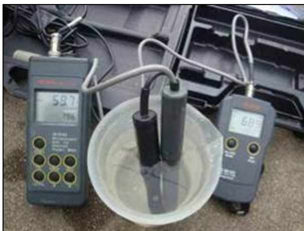
Fotografia 3: Medição do pH, Temperatura, Condutividade e Oxigénio Dissolvido com recurso a sondas portáteis
