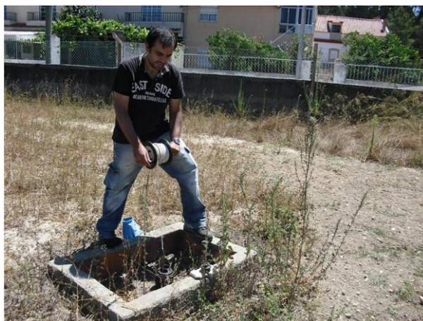
Fotografia 4: Medição da coluna seca com recurso a sonda portátil
