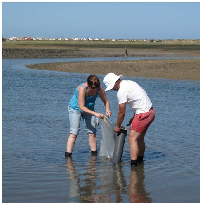
**Figura 1.** O “corer” é um instrumento simples para recolha de amostras de infauna que pode ser operado com pouco esforço.
