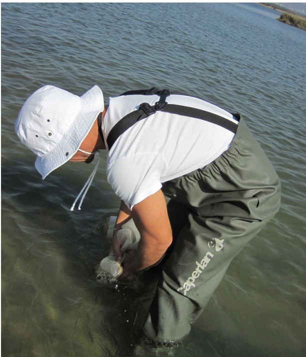
Figura 1. O “corer” é um instrumento simples para recolha de amostras que pode ser operado com pouco esforço por uma única pessoa.
