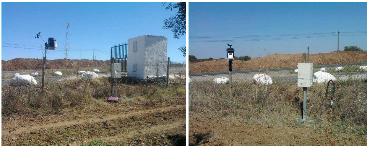
Figura 3 – Perspectiva da estação móvel de qualidade do ar durante as medições realizadas no local de medição M5 – Lanço C.
