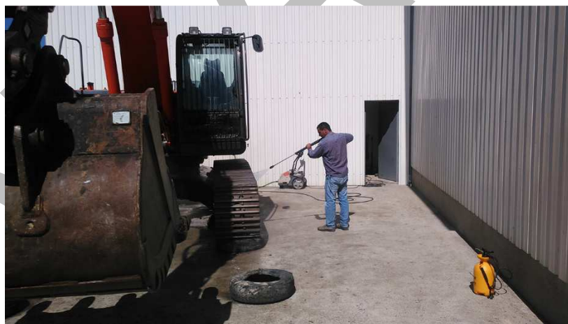
Figura 3 - Lavagem do equipamento com água
