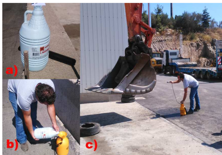
Figura 4 – Desinfecção do Equipamento. a) – Lixívia comercial (1,5% Cloro); b) Enchimento do pulverizador; c) – Aplicação da Lixívia no equipamento.
