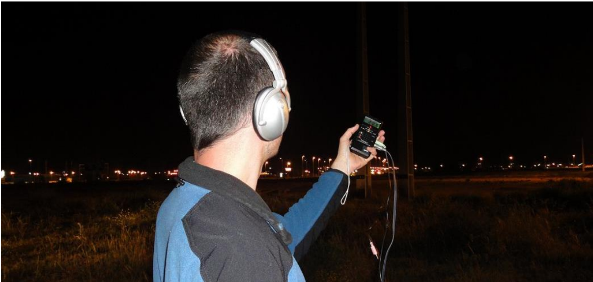
Técnico em trabalho de campo recorrendo ao detetor de ultrassons Pettersson Elektronik AB Mod. D 240 para detetar morcegos (Foto: STRIX)
