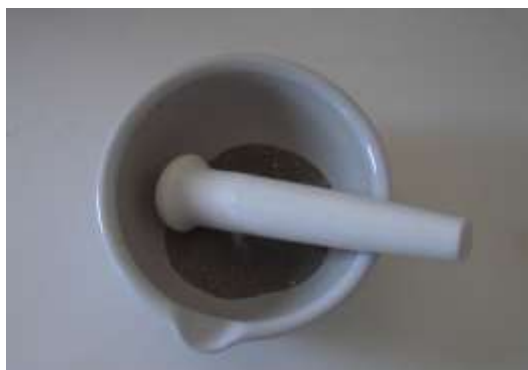
Figura 8 – Determinação do teor em matéria orgânica - moagem do sedimento num almofariz.
