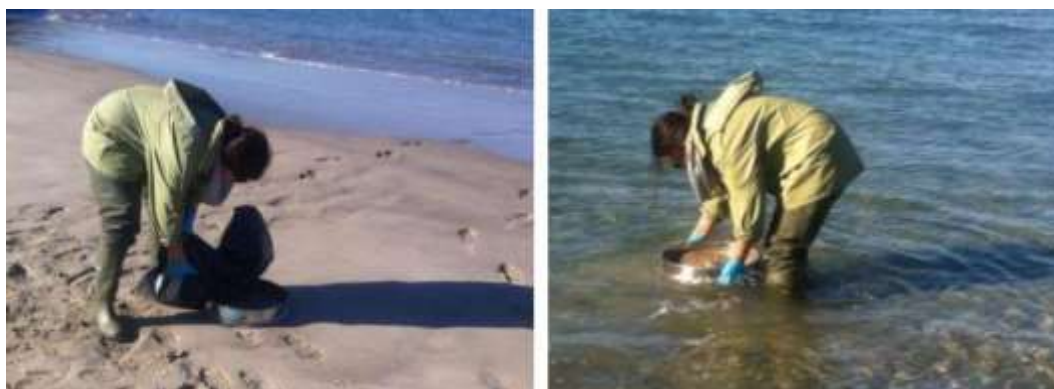
Figura 3. Lavagem das amostras sedimentares no campo com recurso a um crivo de malha 1 mm.
