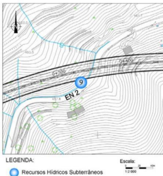
Figura AI.4 – Localização do ponto de amostragem subterrâneo Mina nº 9, ao km 0+325, localizada sob o tabuleiro do viaduto do rio Corgo entre os pilares existentes aos km 0+311 e 0+371.
