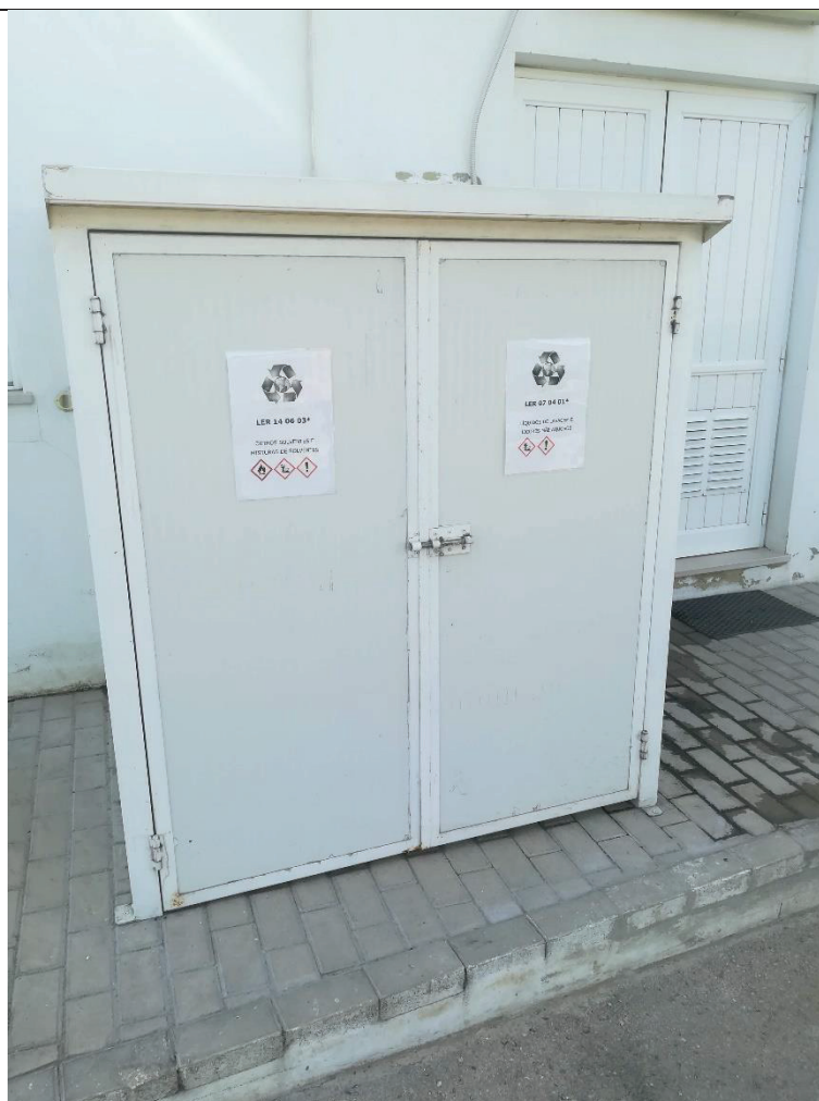
Armazenamento de resíduos de solventes devidamente acondicionados e identificados
