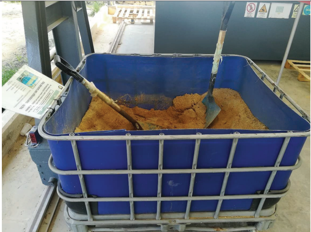
Materiais de contenção de derrames no Parque Estrela 2 (Zona de Liquefação)
