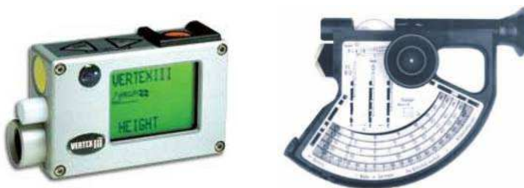
Figura 9 - Hipsómetro digital Vertex III e Hipsómetro Blume-Leiss
