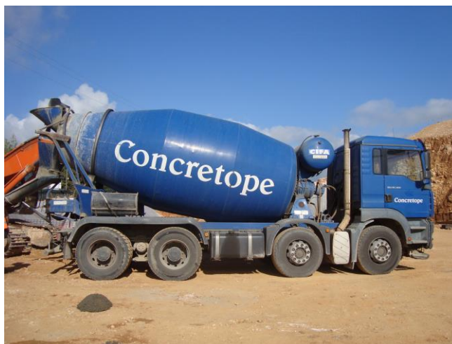
Foto 33 – Auto- Betoneira – Concretos
