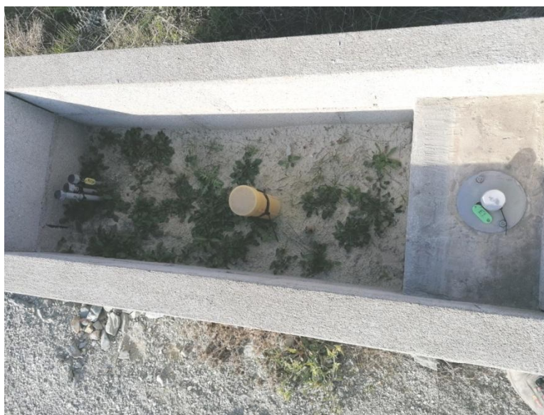
Fig.9 - Extensómetro integrado com inclinómetro e piezómetro triplo.
