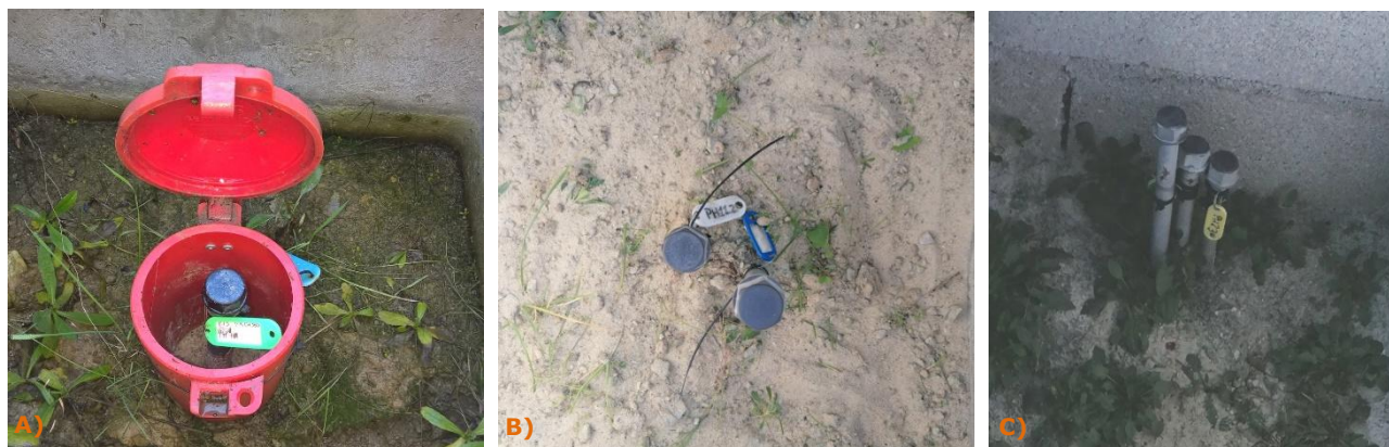
Fig.4 - Aspeto geral dos piezómetros: A) simples, B) duplo, C) triplo.
